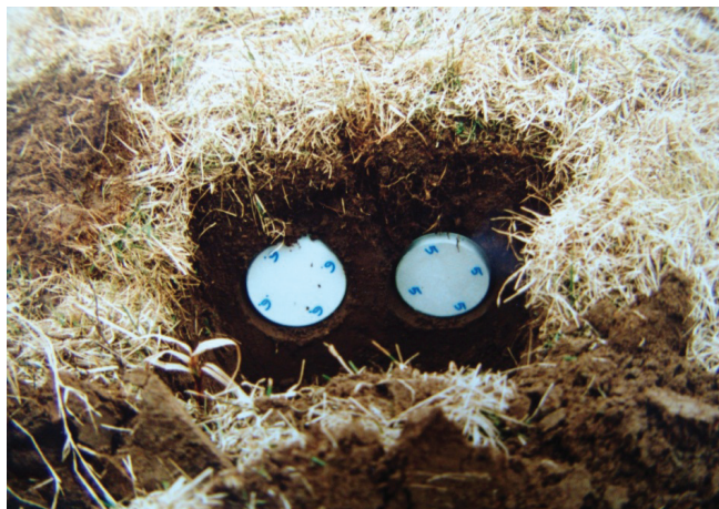
Fot. 1. Sposób umieszczenia wzorców gipsowych w podłożu na terenie zlewni Chwalimskiego Potoku (fot. G. Szpikowska)
