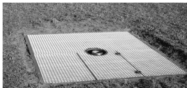
Ryc.5. Deszczomierz Hellmanna jamowy.
