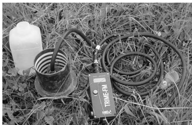
Ryc. 4. Zastosowanie cylindra Burgera i sondy TDR do eksperymentalnych pomiarów szybkości propagacji wilgotności w glebie.
