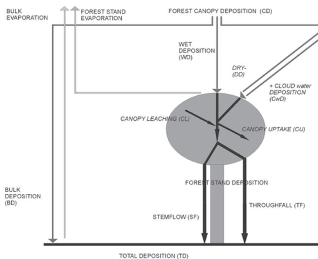
Ryc. 3. Schemat systemu depozycji bezpośredniej, depozycji drzewostanowej i całkowitej z transformacjami w hylosferze
