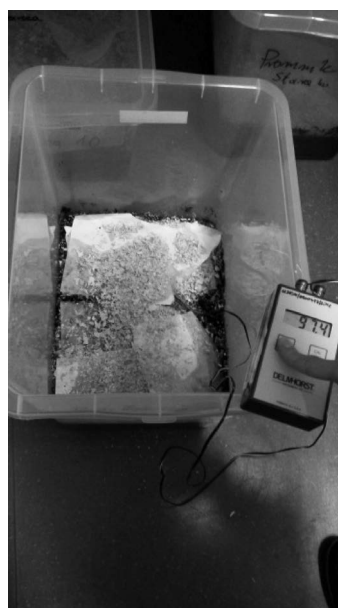
Fot. 4. Pomiar wilgotności (fot. R. Kozłowski)
