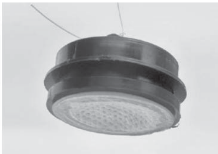
Ryc. 1. Przekrój poprzeczny i widok próbnika \text{SO}_2 i \text{NO}_2 wykorzystywanego w metodzie pasywnej
