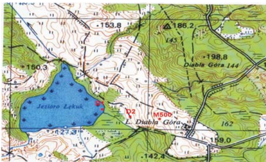
Ryc. 2. Rozmieszczenie ewaporometru na Stacji PB (M500) i deszczomierza (D1) nad jeziorem Łękuk Fig. 2. Distribution of the evaporimeter in the PB Station (M500) and the rain gauge (D1) on the Łękuk lake
